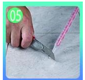
05 Cenderung memotong bagian atas nozzle dalam 45 °.
