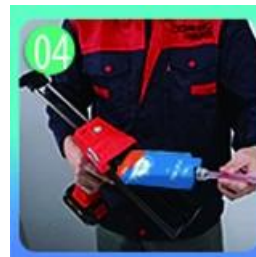
Sekrup pada nozzle, pakai pistol grout.
